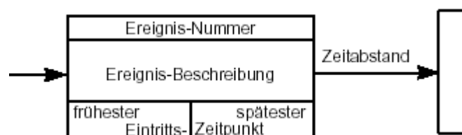
Abbildung 9: Beispiel eines Ereignisknoten-Netzplans (Legende)
